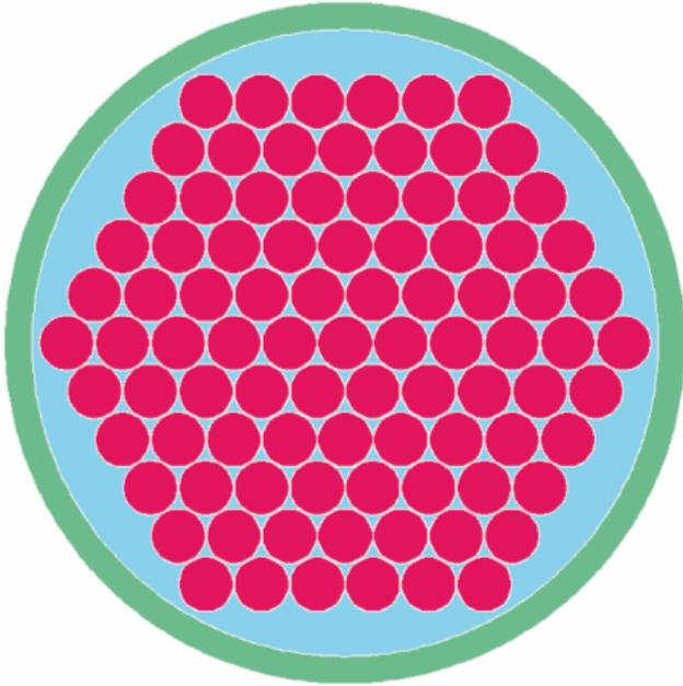
TUNGSTEN PARTICLE BED SPALLATION TARGET
